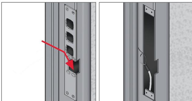
Pour les portes équipées de gâche électrique, vérifier la prédisposition correcte de l'alimentation et sa position pour les branchements à venir.
